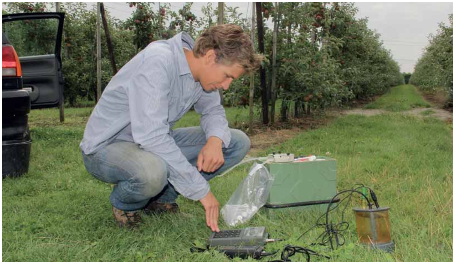
Onderzoeker Koen Zuurbier meet en monitort elke week temperatuur, pH en ec van de zoetwaterbel.
